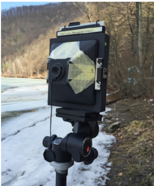
Moja camera obscura iflord od Harman Titan na 4 x 5" kazety, kde vidieť aj mnou naznačené uhly záberu ako pomôcku pre komponovanie záberu.
