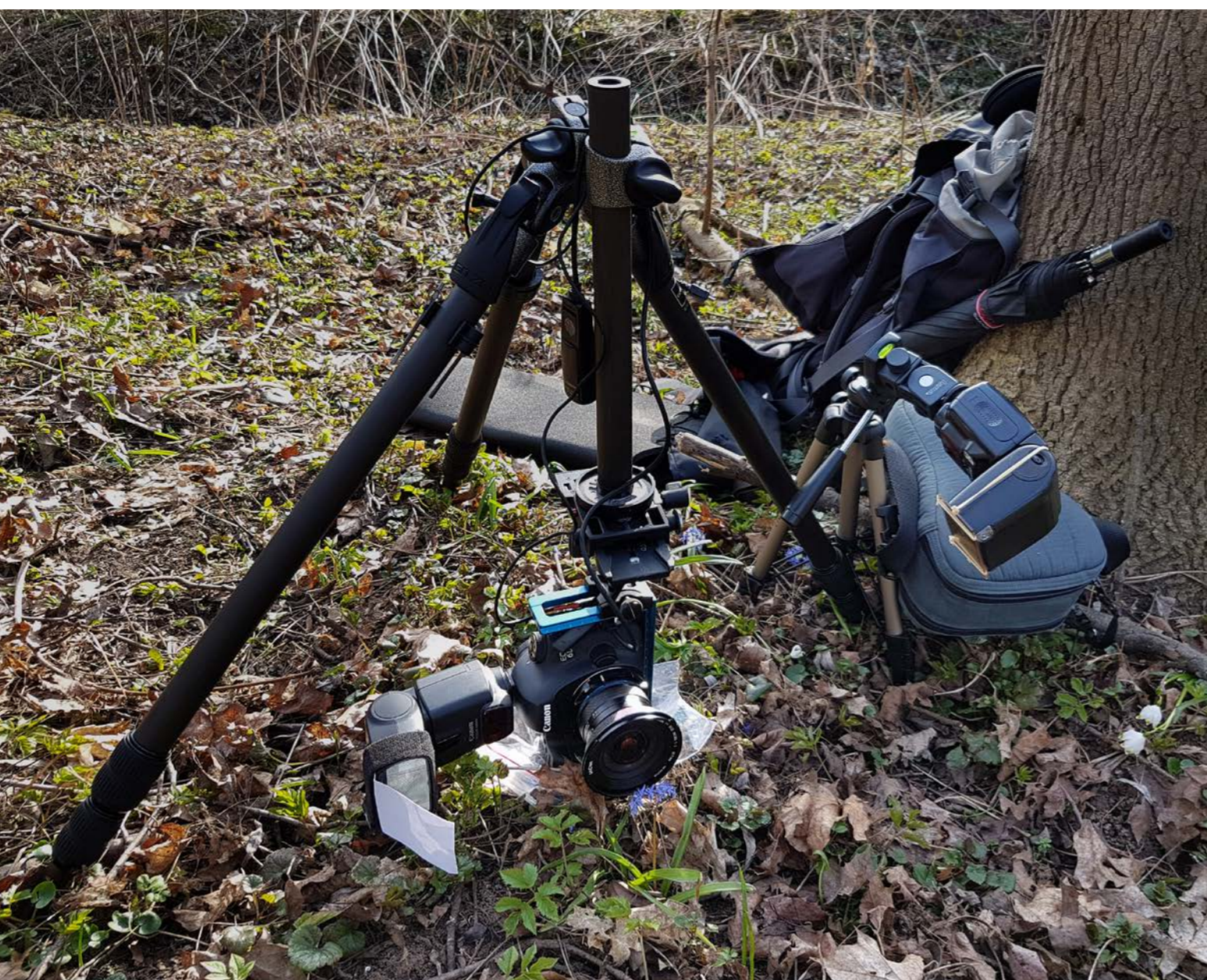
obr. 41 Ukázka snímání makrosnímku za použití širokoúhlého 1:1 makro objektivu Laowa 15mm f/4 a dvou zábleskových světel.
