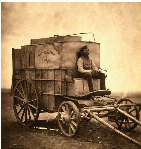
Fotografie 18: Photographic Van, 1855. | Fenton, Roger. Fentonův asistent a jeho fotografický pojízdný vůz Photographic Van tažený koňmi vybavený temnou komorou, 5 kamerami pro kolodiový proces, 700 skleněnými deskami, chemikáliemi, zásobami a nářadím.
