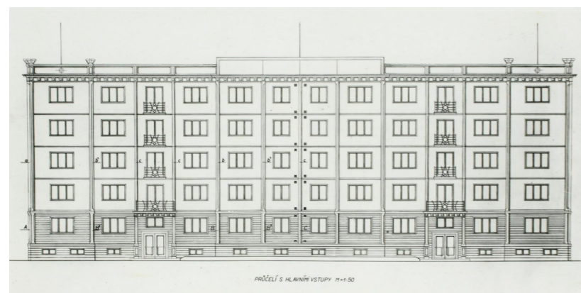
2/ Průčelí prvního panelového domu soustavy G40 z r. 1953.
