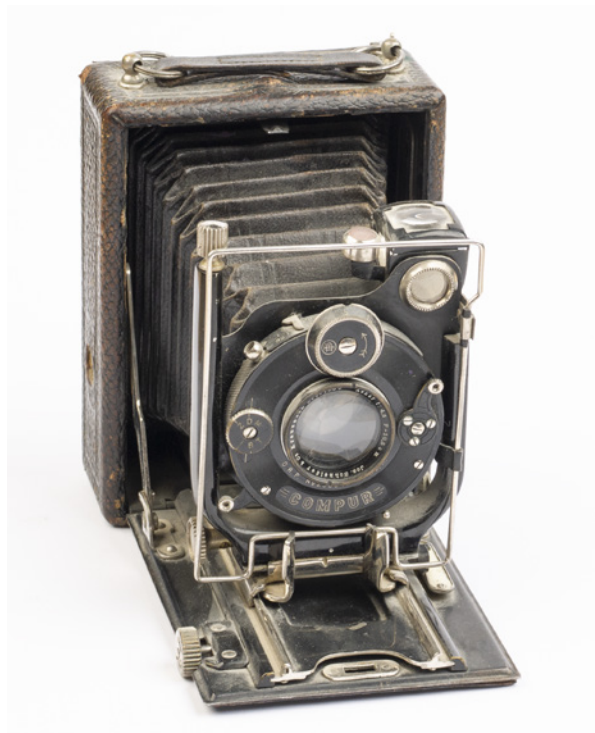
obr. 4. Deskový fotoaparát 9×7 cm s objektivem Schneider & Kreuznach Xenar 10.5cm f/4.5, který Jaroslav používal na reprodukční fotografii.
