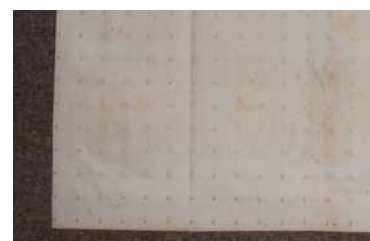
Papír byl uložen v nevhodných podmínkách, v tomto případě se jedná o adjustaci do sololitu, které vedly k degradaci.
