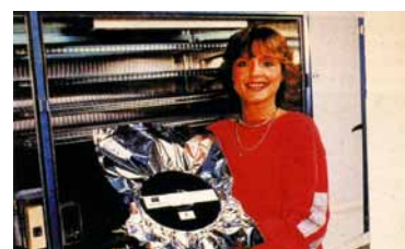
Vakuové balení představuje řešení vysoké relativní vlhkosti při uložení v nízkých teplotách nebo pod bodem mrazu.
