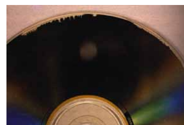
Degradace optického disku – oxidace stříbrné reflexní vrstvy
