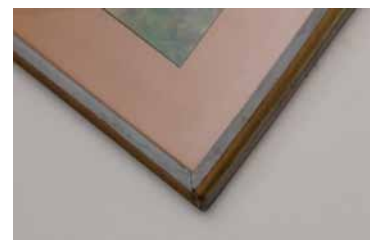
Příklad nevhodné adjustace – materiál pasparty a pozadí je stejný, v případě pasparty došlo k jeho degradaci.
