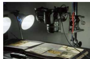
Příklad jednoduchého pracoviště určeného k pořízení digitálních reprodukcí
