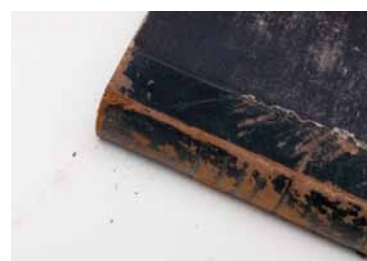
Poškozená kožená vazba – kůže ztrácí své fyzikální vlastnosti a rozpadá se do šupin.
