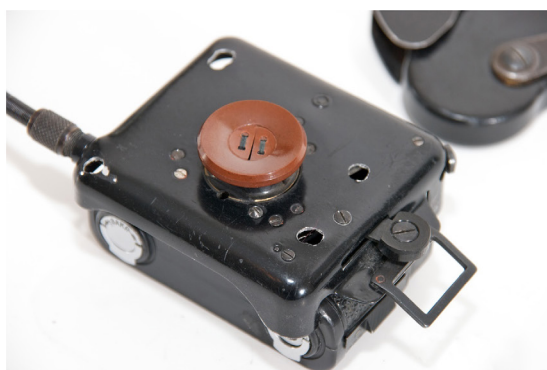
Aparát F-21 Ajax s mechanismem pro vychýlení knoflíku kryjícího objektiv
