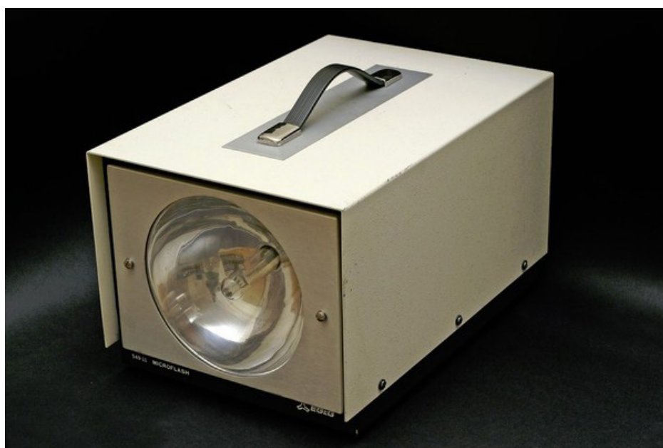
EG & G Microflash 549 blesk pro ultra rychlé fotografování, projekt H. Edgerton.
